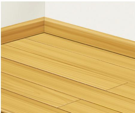
**03** Mit Abschlussleisten wird nun die Abstands-fuge und die Verschraubung abgedeckt.
